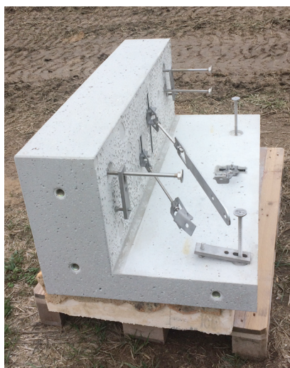
Univerzita Palackého v Olomouci - kotvení fasády s lezeckou stěnou.
